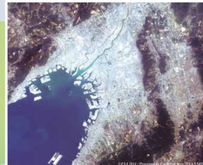
Fig. 2 - Immagine multispettrale rilevata dall'OLI di Landsat-8 il 17 marzo 2014 e visualizzata in colori naturali (RGB 432) (cortesia ESA).
